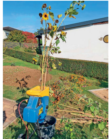
Stängel können gut in einem Walzenhäcksler zerkleinert werden.
